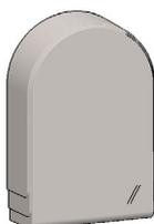
La sonda esterna deve essere installata su una parete a Nord o Nord-Ovest dell'edificio, ad un'altezza da terra di almeno 3 metri, in una posizione non esposta a correnti d'aria improvvise, al riparo dall'azione dei raggi solari o di altre fonti di calore e al riparo da urti ed eventuali manomissioni.
